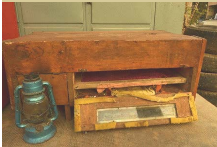
Gros plan de la couveuse artisanale conçue par un ancien élève du CIDAP
